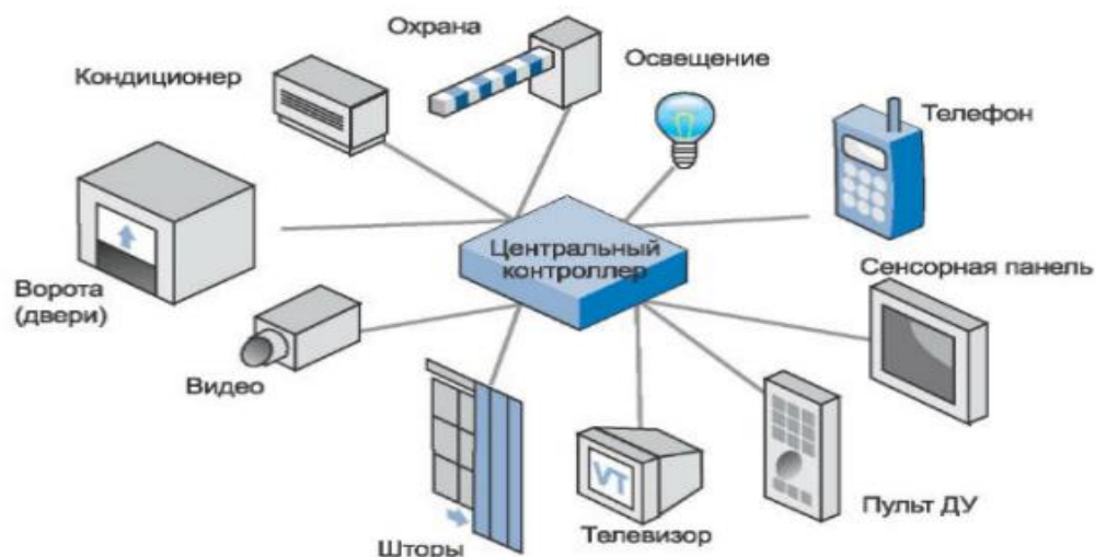
Рис. 2.1 Схема организации сети «умный дом»
